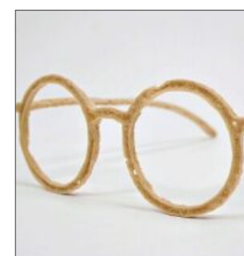
Der Prototyp eines Brillengestells aus Chitosan. Foto: Max Greiner
